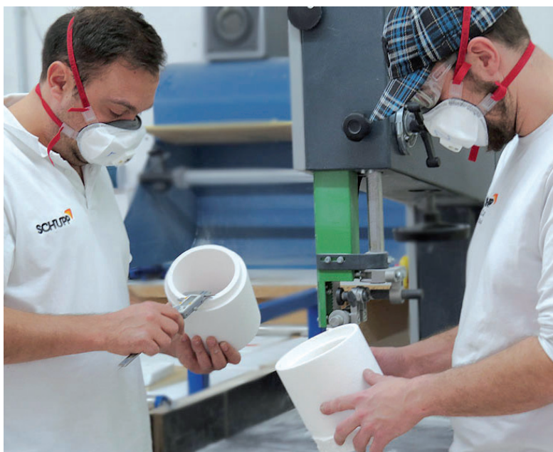
Bild 2 Bearbeitung und Qualitätssicherung von UltraVac-Formteilen (Bild: SCHUPP® Ceramics)
