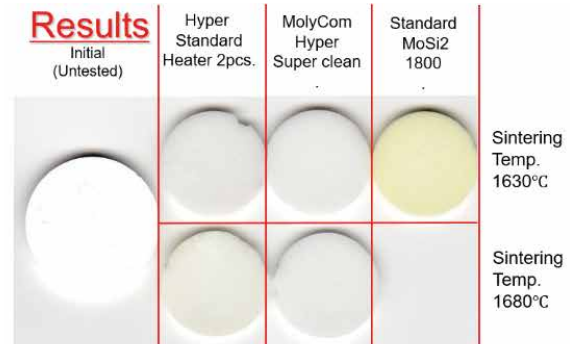
Abb. 5: Farbveränderung bei verschiedenen Heizelementqualitäten.
