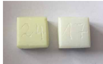
Abb. 9: Probe 24 wurde auf einem geschlossen Saggar (Brennschale) gesintert. Probe 17 war im Saggar im gleichen Brand in einem verunreinigten Ofen.
